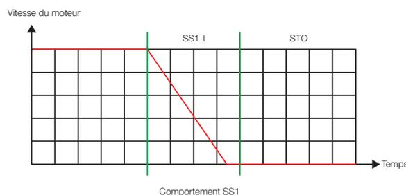
Remarque : 1) Les fonctions de sécurité STO et SS1 sont disponibles dans la version Y2 du CFW500. Elle remplit les exigences de performance de sécurité SIL 3 / PL e, conformément aux normes IEC 61800-5-2, EN ISO 13849-1, EN 62061, IEC 61508 et IEC 60204-1.
