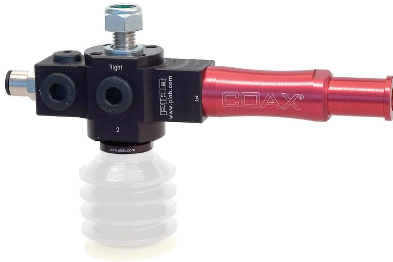
Piab VGS™ – Ein Produktdesign, in das verschiedene Saugnapfe mit Vakuum-Cartridges basierend auf der COAX®-Technologie integriert sind. Der „Vakuum-Greifer“ erleichtert die Auswahl, Bemessung und Installation eines Vakuumsystems. Mit einem VGS™ genießen Sie die Vorteile eines kostengünstigeren und zuverlässigen, dezentralen Vakuumsystems. Es wiegt nur 413-679 g.
