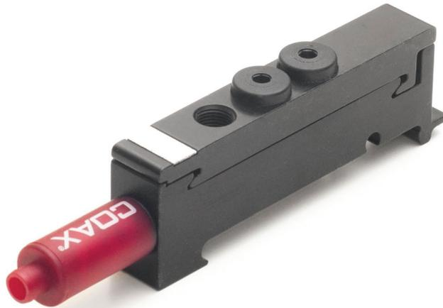
Kompakte/stapelbare Vakuumpumpen sind luftbetriebene, mehrstufige Ejektor-Baureihen, die auf der COAX®-Technologie basieren. Sie verfügen über integrierte Steuerungen und Spezialfunktionen, wie das Ein-/Aus-Ventil, Abblasventil, Vakuumschalter, Energiesparfunktion usw. Sie sind konfigurierbare Plattformen, mit denen sich die genauen Steuerfunktionen für das System einfach spezifizieren lassen.
