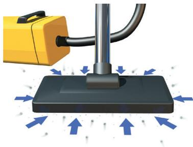
Ein Staubsauger saugt nicht. Luft und Staub werden vom höheren atmosphärischen Druck der Umgebung in den Staubsauger gepresst.
