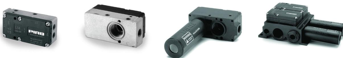
Diese Pumpenbaureihe bietet eine große Saugleistung, obwohl sie sehr klein und leicht sind. Vakuumniveau bis 75 -kPa. Manche Pumpen dieser Baureihe sind mit einer Anschlussplatte aus Aluminium oder PA-Verbundwerkstoff erhältlich. Ihre Verwendung wird empfohlen, wenn das behandelte Produkt aus porösem Material wie Karton, Holz oder Papier besteht.
