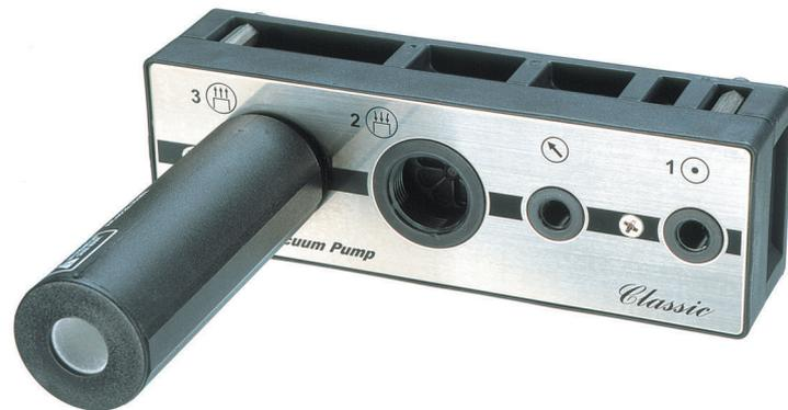
Eine herkömmliche Piab-Vakuumpumpe, die für den Einsatz in der chemischen Industrie oder in chemisch aggressiven Umgebungen entwickelt wurde. Sie erreicht höhere Vakuumniveaus, sogar bis zu 99,8 -kPa. Die Vakuumpumpe Classic H40 besteht aus PPS-Verbundwerkstoff. Wir empfehlen ihre praktisch leckagefreie Verwendung in nicht porösen Anwendungen.
