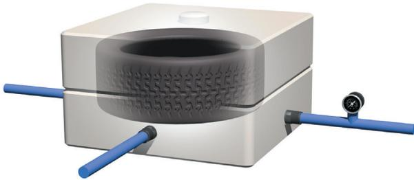
Reifen geformt unter Vakuum
