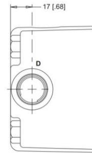
**D:** 10 Series/2-Way Valve Cavity 7/8-14 UNF
