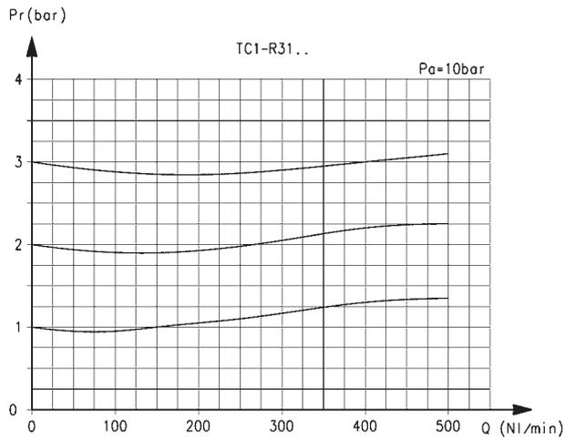
Pr = Ausgangsdruck
