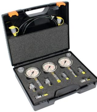
Messbox (analog) mit SPG-063 (3x)
