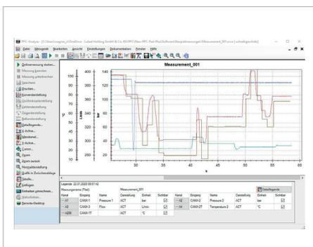
Mit der im Lieferumfang enthaltenen Software PPC-Analyze lassen sie die aufgenommen Kurvenverläufe anzeigen, analysieren und exportieren.
