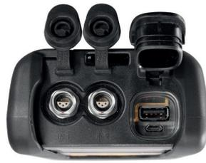
PPC-04-plus mit 2 Sensoreingängen für max. 2 analoge Sensoren
