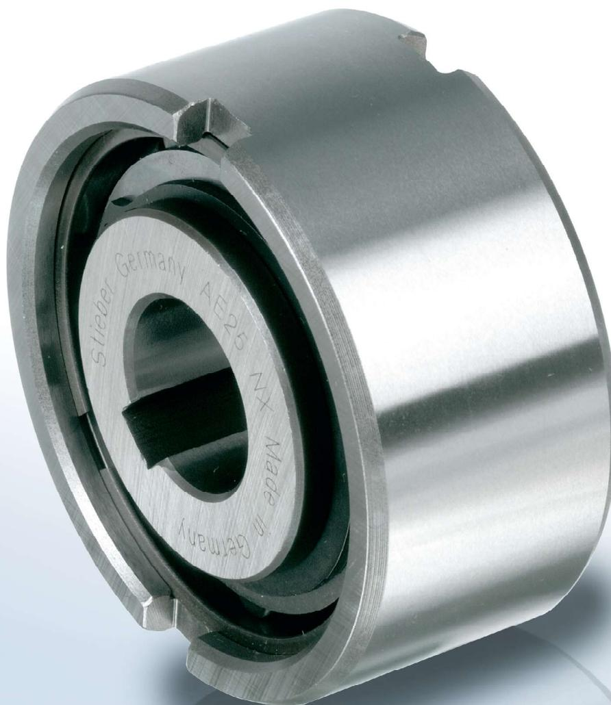
Le modèle AA est une roue libre à rouleaux non autocentrée. Il est nécessaire de l'intégrer dans un montage fournissant roulements, lubrification et étanchéités.
