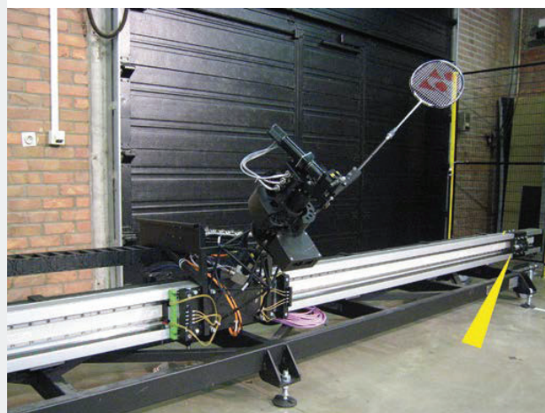
Různé tlumiče brzdí rychlé pohyby badmintonového robota FMTC vzw, 3001 Leuven, Belgie
