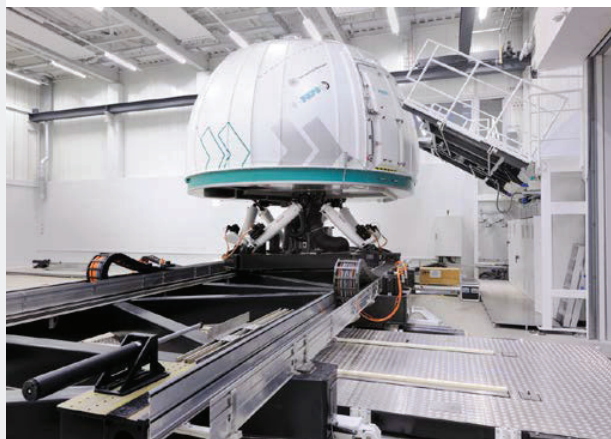
Bezpečnostní tlumiče ACE chrání koncové polohy ve dvou osách jízdního simulátoru Bosch Rexroth B. V., 5281 RV Boxel, Nizozemsko a Univerzita ve Stuttgartu - FKFS, 70569 Stuttgart, Německo
