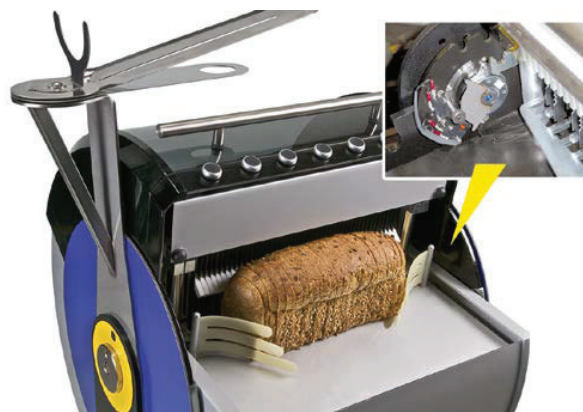
Ochranný kryt, zabezpečený rotačními brzdami: Poté jde snadná obsluha kráječe chleba naprosto lehce od ruky Daub Bakery Machinery BV, 5050 AB Goirle, Nizozemsko
