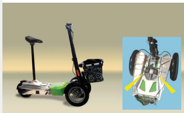
Deformační tlumiče zvyšují jízdní komfort elektro skútru
