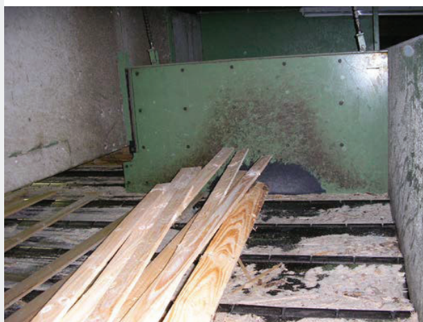
Nárazová ochrana pro dřevěné lišty Stora Enso Timber AG, 2601 Sollenau, Rakousko
