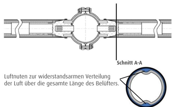
Luftnuten zur widerstandsarmen Verteilung der Luft über die gesamte Länge des Belüfters.
