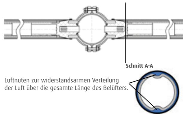
Luftnuten zur widerstandsarmen Verteilung der Luft über die gesamte Länge des Belüfters.
