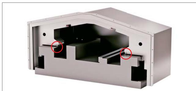
Bei **DUAL BARRIER 2EVO** liegt nur die Teleskopabdeckung auf den 2 Führungen auf, der Faltenbalg wird durch in der Abdeckung integrierte Halterungen gestützt.
