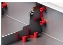
Bei hohen Verfahrgeschwindigkeiten werden in diesem Bereich **P.E.I. Stoßdämpfer** (patentiert) eingesetzt. Die Stossdämpfer werden aus einem kühlsmiermittelbeständigem Polymermaterial hergestellt. Sie verringern gleichzeitig die Geräuschbelastung und den Verschleiß während des Arbeitsablaufs.
