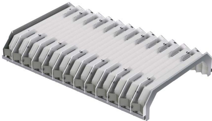
In den Schenkeln befinden sich Kunststoffscharniere die steif genug sind, um ein Umkippen zu verhindern, jedoch flexibel genug um das Öffnen und Schließen des Mechanismus zu gewährleisten. Das System ist so konzipiert, dass alle Rahmen parallel und vertikal zueinander bleiben.
