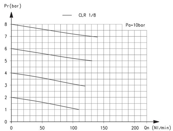
$P_a$  = P Eingangsdruck (10 bar);  $P_r$  = P Regeldruck;
