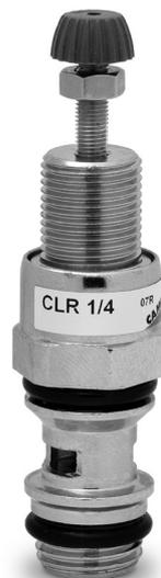
Die Miniaturregler Serie CLR sind mit den Anschlüssen G1/8" und G1/4" verfügbar. Es handelt sich um einen Kolbenregler mit oder ohne Sekundärentlüftung. Die Hohlschraube dieses Reglers besteht aus Messing/vernickelt, der in seiner Lage einstellbare Anschluss/Ringstück aus Kunststoff. Die Regler können ohne oder komplett mit Steckanschluß geliefert werden und ermöglichen auch eine Schalttafelmontage.
