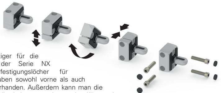
Am Betätiger für die Schalter der Serie NX sind Befestigungslöcher für M5-Schrauben sowohl vorne als auch seitlich vorhanden. Außerdem kann man die beiden Halbschalen, aus denen der Körper des Betätigers besteht, öffnen und den Bolzen drehen, so dass man die Arbeitsebene des Betätigers um 90° drehen kann.
