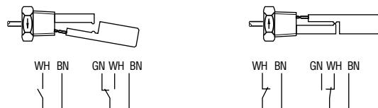
Schaltpunkt bei einer Neigung von  $\alpha = 12^\circ \pm 3^\circ$  am Drehpunkt vom Schwimmer, gemessen ohne Medium – Bitte beachten Sie, dass die Behälterwandstärke min. 3 mm betragen muss.
