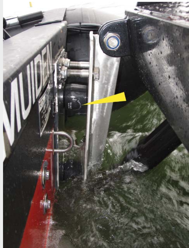
Les absorbeurs profilés TUBUS, robustes et résistants à l'eau de mer, en élastomère de type copolyester, permettent aux bateaux et aux équipages d'amarrer en toute sécurité
