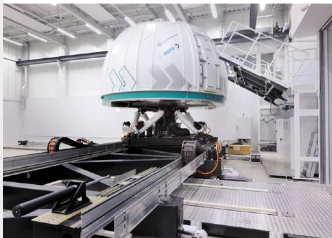
Des amortisseurs de sécurité d'ACE protègent les positions finales de deux axes d'un simulateur de conduite Bosch Rexroth B. V., 5281 RV Boxtel, Allemagne et Université de Stuttgart - FKFS, 70569 Stuttgart, Allemagne
