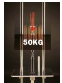
Démonstrateur ACE : chute libre d'un verre de vin d'une hauteur de 1,3 m. Ralenti par un amortisseur sans répandre une seule goutte de vin.
