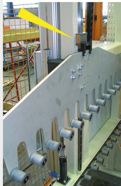
Accumulateur de matériau sécurisé
