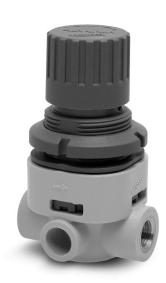
Les régulateurs de pression Série T existent en taille 1/8" et 1/4" (insert laiton) En standard, les régulateurs à piston sont pourvus d'une décompression automatique (relieving) permettant un réglage de la pression à la descente. Une version sans décompression automatique est aussi disponible.
