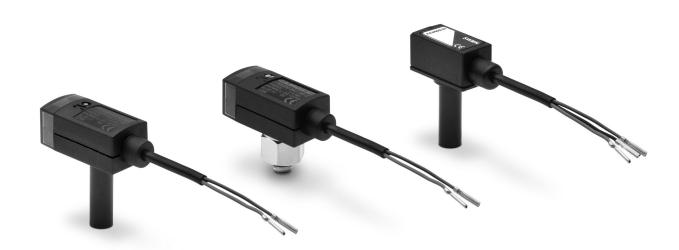
Les pressostats de la série SWMN peuvent être installés directement au point de mesure ou au point de détermination de la pression/du vide dans les systèmes de manutention, grâce à leurs dimensions très compactes. Son poids réduit (seulement 50 grammes avec un câble de 2 mètres) et sa construction robuste permettent son installation sur des applications à fortes accélérations.
