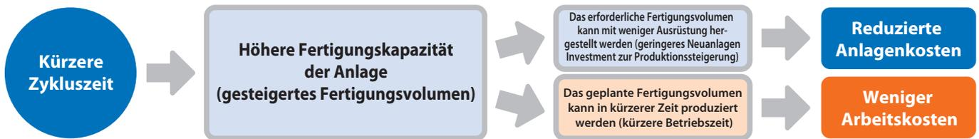
Pneumatikzylinder können aufgrund der Stoßwirkung, die am Hubende bei zu hoher Geschwindigkeit auftritt, nicht mit hoher Geschwindigkeit betrieben werden. Der **EleCylinder** ermöglicht die individuelle Einstellung der Parameter BGV mit prozentualer Eingabe für weiches Starten/Stoppen bei hoher Geschwindigkeit. Dies hat eine geringere Zykluszeit zur Folge.
