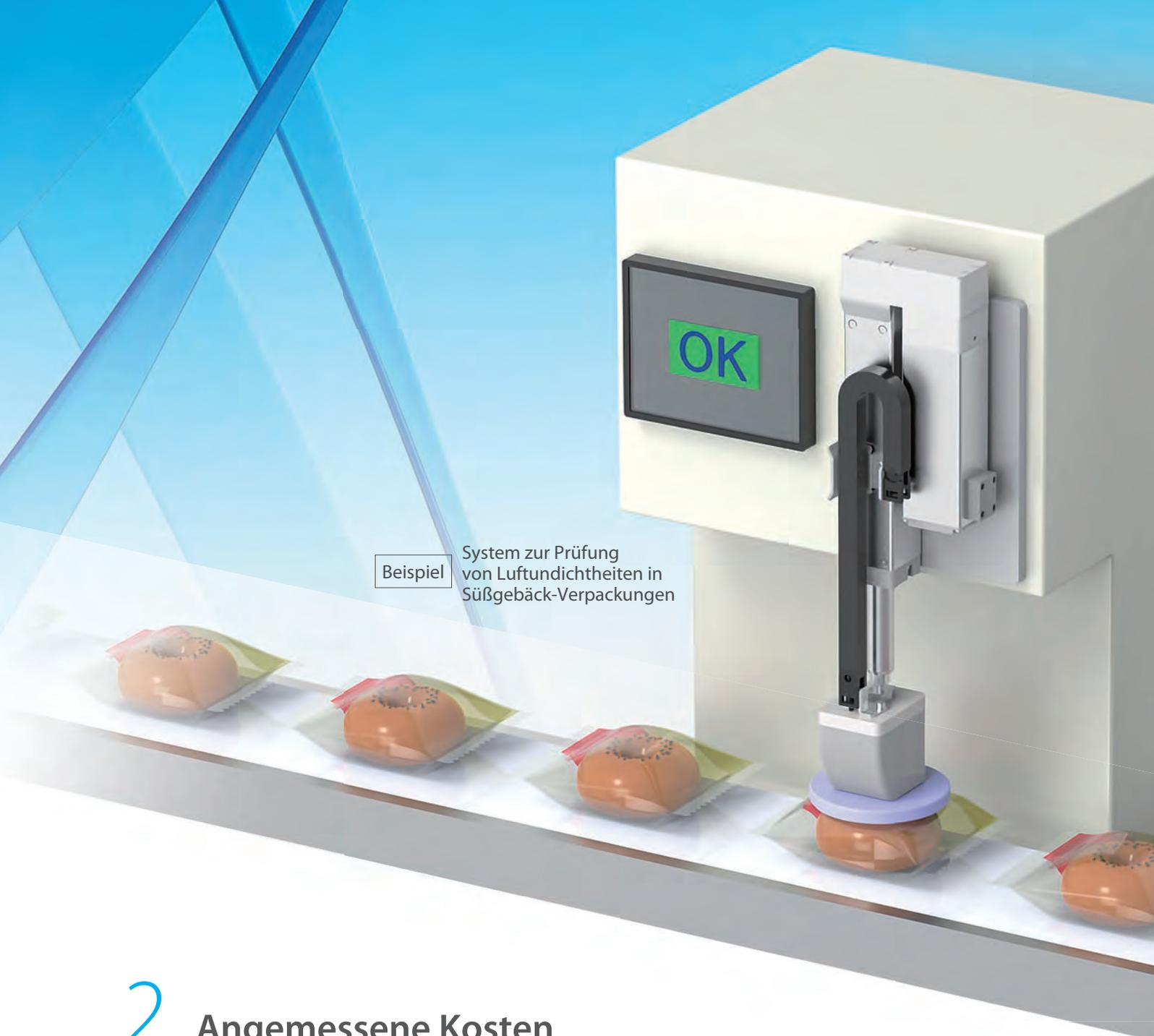
Beispiel System zur Prüfung von Luftundichtheiten in Süßgebäck-Verpackungen
