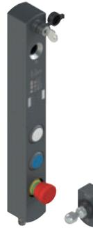
Actionneur verrouillé à électroaimant 24Vdc **désexcité**. Avec déverrouillage à serrure et bouton de déverrouillage antipanique.
