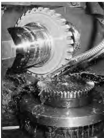
CNC-Bearbeitung eines PowerTRUE™ Zahnrades in rechtwinkliger Bauform
