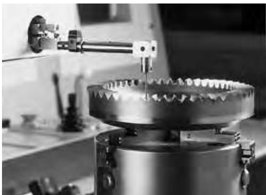
Computervermessung eines Zahnprofils
